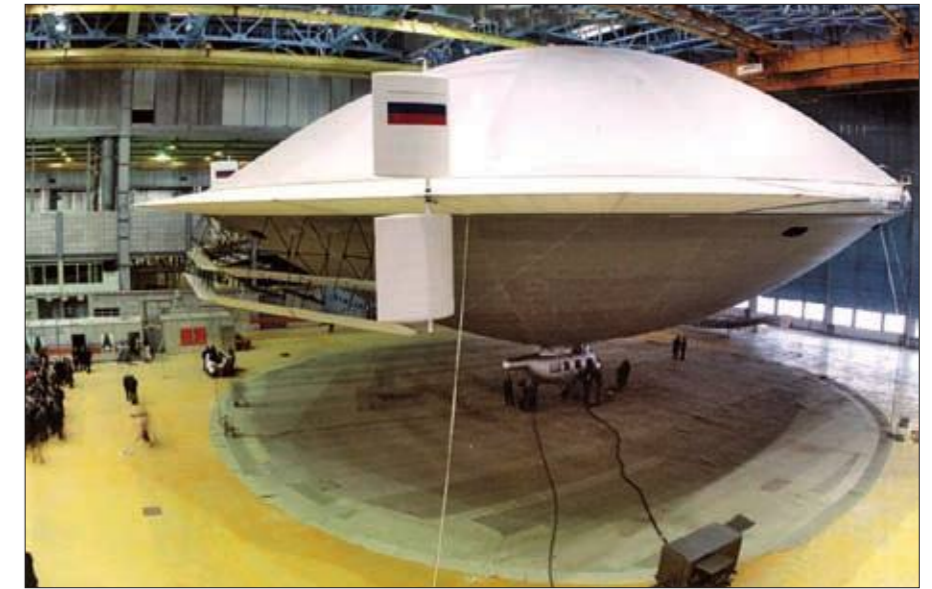
Термоплан АЛА-40 в цехе ульяновского завода
